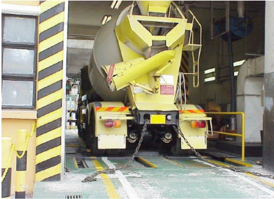
使用底盤式功率機進行車輛黑煙測試
